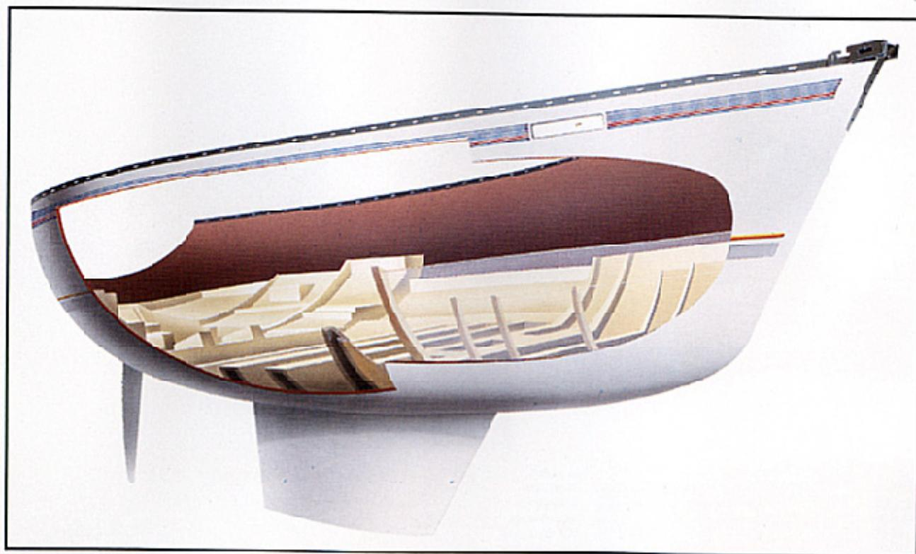
*Principe de l'ossature d'une coque: le contre-moule et les varanques.*
