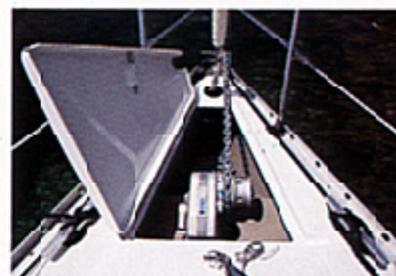
Le quincau intégré dans le puits à mouillage.
