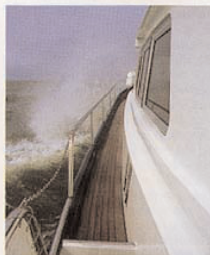
Het zetwerk levert mooie details op; let ook op de waterkering in het 40 cm brede gangboord.
