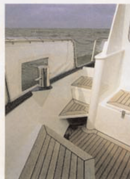
Een trede geeft vanuit de kuip toegang tot het gangboord. Let ook op de mooi afgeronde boldersteun. Door het luik van de bank tegen de opbouw te openen kom je in de machinekamer. De toegang lijkt op de foto wellicht krap, maar is dat geenszins.
